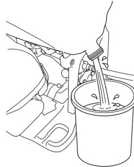
3. Instale el tapón de drenaje y quite el tapón del depósito de componentes químicos para verter agua en su interior y enjuagarlo.
